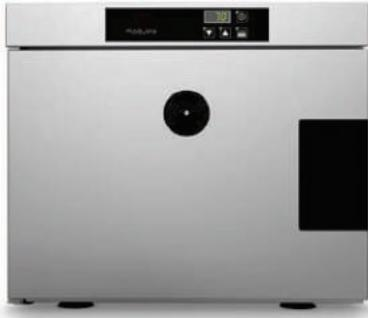
statisches Ring-Heizsystem mit Thermokabel, optimales Heißhalten durch exakte und kompakte „stille Wärme“, 2 einstellbare Entlüftungen, dichter Garraum mit Wärmeisolierung 35 mm und abgerundeten Ecken für perfekte Hygiene, niedriger Energieverbrauch, Bedienfeld mit elektronischer Einstellung für die Temperaturen, Kapazität für 3 Einschübe GN 1/1 (530x325 mm), Einschubabstand 70 mm, Temperaturbereich 30° -90°C
